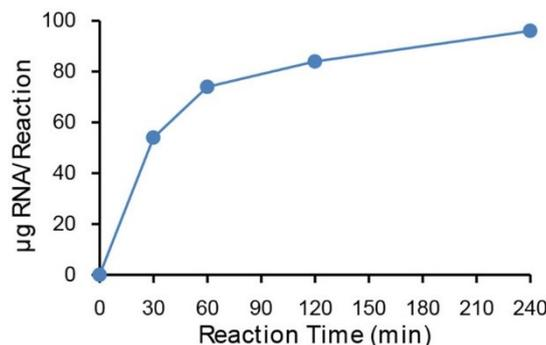
图1. 碧云天的SP6 High Yield Transcription Kit以带有SP6 Promoter的线性化质粒DNA为模板进行转录时的产量参考图。在20 $\mu$ l反应体系中, 通过使用1.0 $\mu$ g 2878bp的线性化质粒DNA为模板, 在37 $^{\circ}$ C分别孵育0、15、30、60、120、240min, 随后70 $^{\circ}$ C孵育10min终止反应。加入等体积水后再加入1 $\mu$ l DNase I, 37 $^{\circ}$ C孵育15min消化模板DNA, 得到的RNA转录产物的长度为198nt。用苯酚/氯仿抽提以及乙醇沉淀并用微量紫外分光光度计检测得到的RNA产物量。实际产量会因具体实验条件的不同而产生差异, 本图仅供参考。
